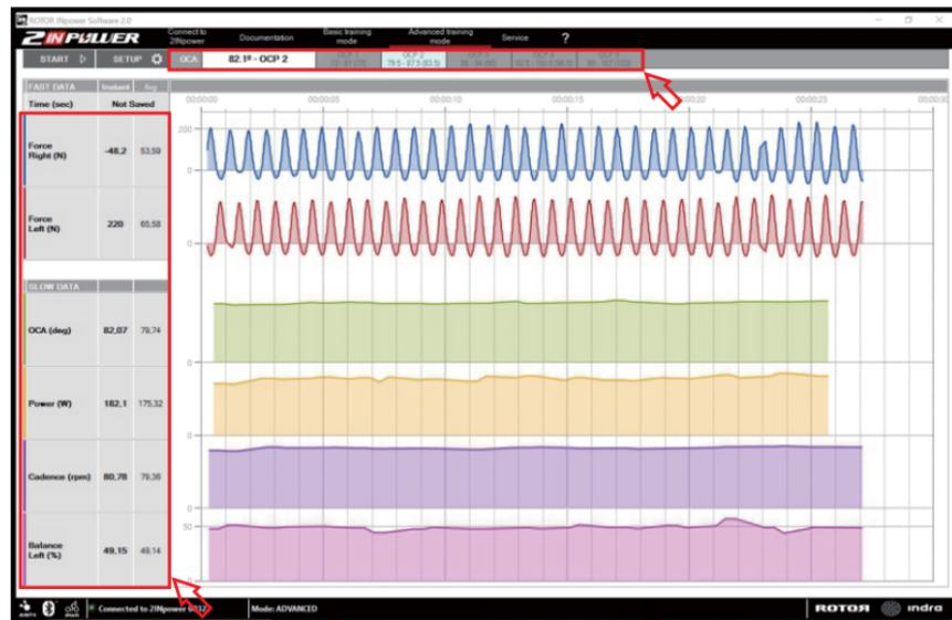
TORQUE 360とリニアグラフの両方において、左側の欄は選択したパラメータの実測値および平均値を示しています。
