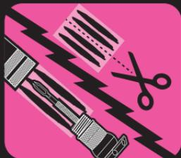
3. ラバーシティックシートを、移動中に保管するために必要な分位数にカットします。スベアとして、バンクプラグツールキャップ内部に3~4個の追加のラバーシティックを入れておきます。
