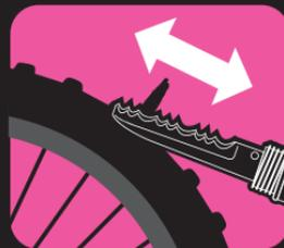
8.最後に、ナイフを使用してスティックの端を慎重に切断します。自転車用のノンドライブサイド側に立ち、自転車から離れることをお勧めします。タイヤから3~5mm以上突き出ているように切断します。
