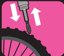
2.パンク部分に中型以上のラバースティックが必要な場合は、ツールのヤスリ目部分で穴を数回拡大させます。チューブレステープやタイヤの壁を傷つけないように、必ず45度の角度で使用し、タイヤの方向に従ってください。
