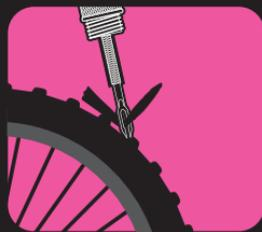
5.パンク穴を見つけて、スティックが半分くらいになるまで、ツールを穴に挿入します(45度の角度で、タイヤの方向に従って、チューブレステープやサイドウォールを損傷しないようにします)。スティックの端がタイヤの外側に残っていることを確認してください。
