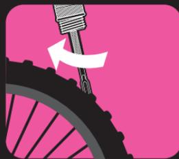
6.ツールを時計回りに数回転ゆくりと回してタイヤ内のスティックをねじり、ゆくりと引き上げて取り外します。スティックをタイヤに残し、穴を塞ぎます。
