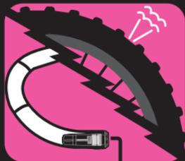
1.パンクの原因を特定し、破片またはパンクの原因を取り除きます。4mm六角レンチを使用してバーからツールを取り外します。
