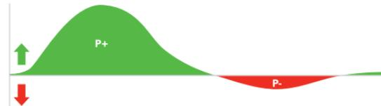
**ペダルスムーズネス**：ペダリングが円運動に近いのか、ピストン運動に近いのかを読み取るのに用います。その値は、各回転での合計トルクと最大トルクとの比となります。
